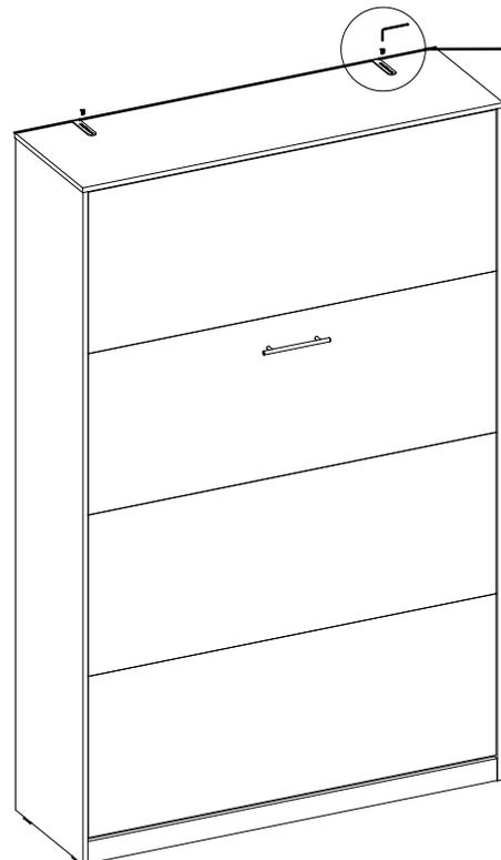
**DE** Die Wandhalterung «ZPK» muss mit geeigneten Dübeln an der Wand befestigt werden.
