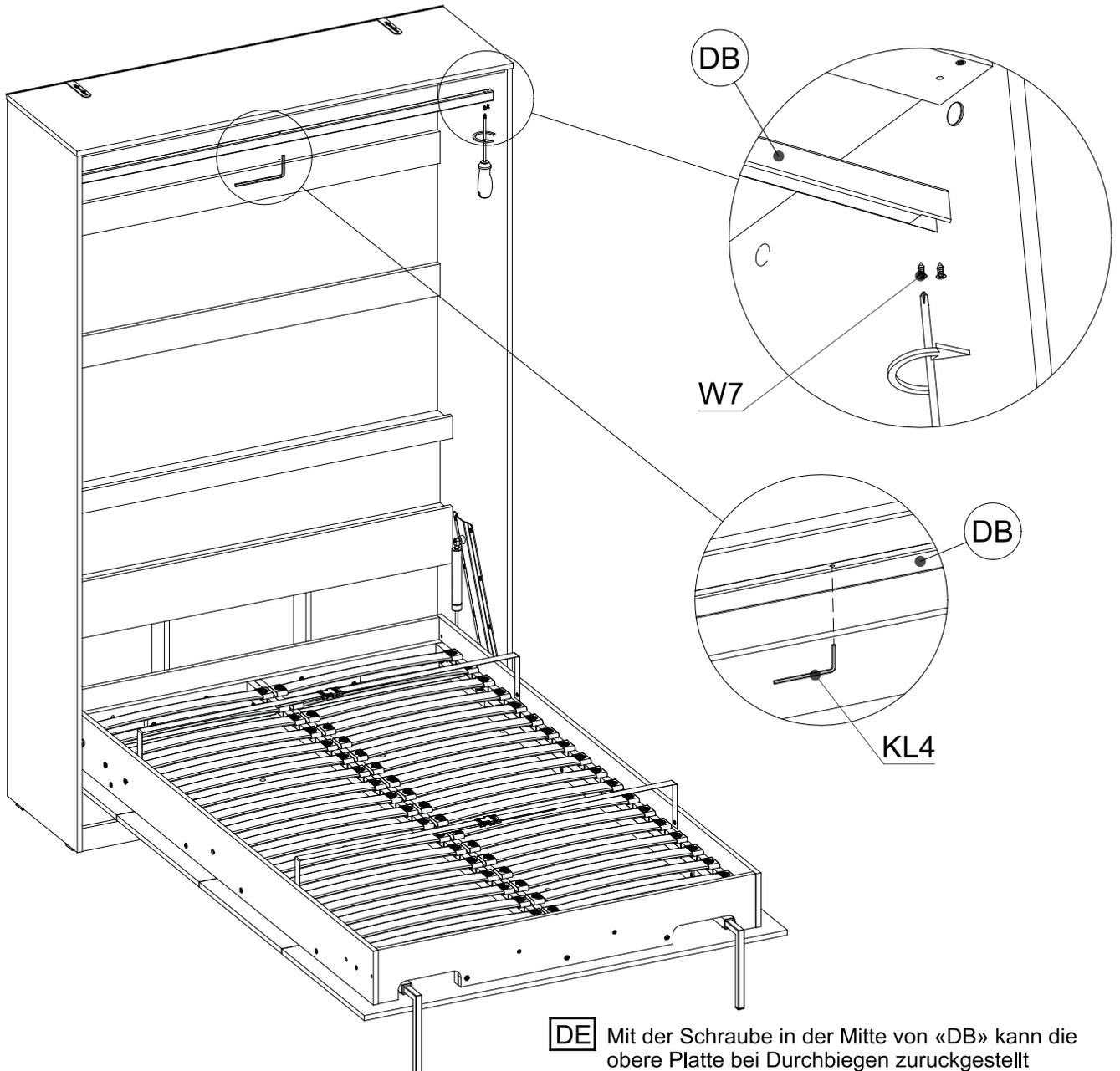
**DE** Mit der Schraube in der Mitte von «DB» kann die obere Platte bei Durchbiegen zurückgestellt werden.
